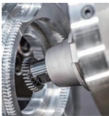
m0.2 ~ m8.0 までの内・外歯ギア・スプライン用スカイピング工具を超硬専門メーカーのノウハウで提供します。詳しくは弊社窓口までお問い合わせください。
